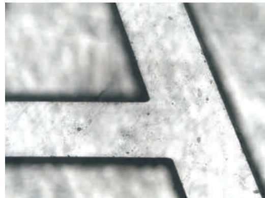
50 µm Löcher in einer 50 µm Stahlfolie. Der Scanner führt dabei einen 20-µm-Fokus auf dem Material.
