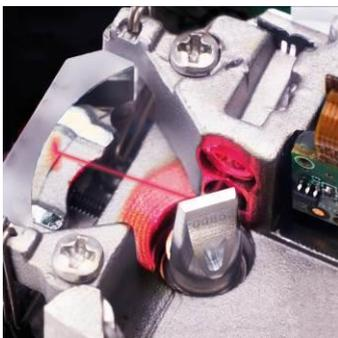
In Laser-Bearbeitungssystemen werden Galvanometer-Scanner als hochdynamische Antriebe für die genaue Positionierung des Lasers auf dem Werkstück genutzt. Mit Hilfe der auf den Galvanometern angebrachten Spiegel wird der Laserstrahl für die jeweilige Anwendung präzise geführt. Kernkomponenten sind der Galvo-Motor, basierend auf Moving-Magnet-Technologie, sowie ein Positionsdetektor. Bisher wurde in digitalen
