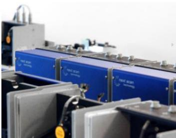
UKP-Laser eignen sich besonders gut für die hochpräzise Mikrobearbeitung verschiedener Materialien, da dank kalter Ablation besonders fein und gezielt Material abgetragen werden kann. Um eine industrietaugliche Produktivität zu erreichen, werden UKP-Laser idealerweise mit ultraschnellen Scannern – beispielsweise einem Polygon-Scanner – kombiniert. SCANLAB hat im Jahr 2014 sein Hybrid-Polygon-Scan-System vorgestellt.
