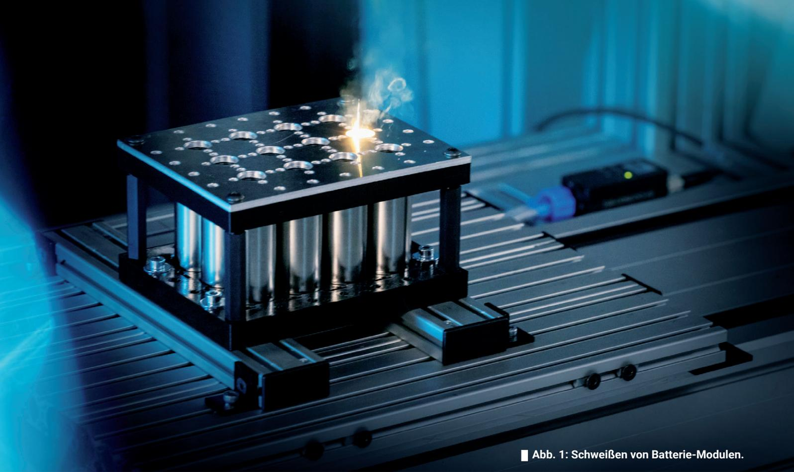
■ Abb. 1: Schweißen von Batterie-Modulen.
