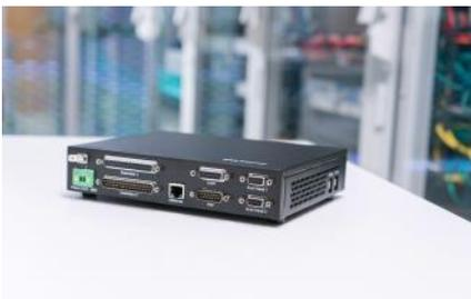
Standards, genormte Bauteile und einheitliche Befestigungssysteme vereinfachen den betrieblichen Alltag und den Aufbau von komplexen Maschinen. Mit der praktischen RTC6 EtherBox macht SCANLAB die Ansteuerelektronik von Laserbearbeitungssystemen zu einem leicht zu integrierenden „Klick-in-System“. Die handliche Box mit einem hochwertigen,
