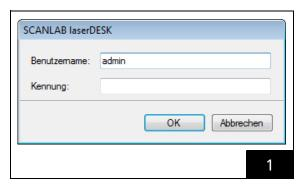
Wenn nur eine RTC-Karte (RTC5 oder RTC6) im PC eingebaut ist, öffnet sich das Programmfenster sofort.
