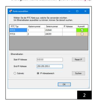
In diesem Fall wählen Sie die gewünschte RTC-Karte aus, indem Sie das entsprechende Kontrollkästchen in der Spalte 'Auswahl' aktivieren und mit {OK} bestätigen.
