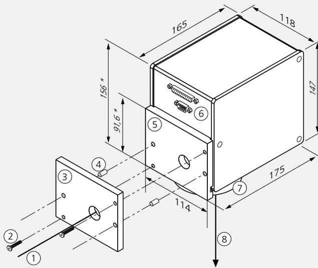
Die angegebenen Abmessungen beziehen sich auf den **Standard-Gehäusetyp** mit 10 mm Apertur. Es sind Abweichungen bezüglich Höhe und Tiefe des Gehäuses möglich; auch Gehäuse mit Wasserkühlung haben andere Abmessungen.
