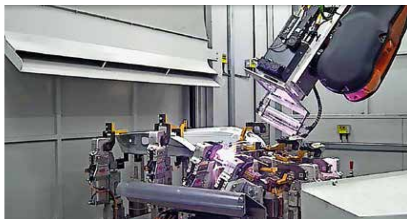
Bei der Herstellung der Türen für die neue BMW Mini-Generation zieht das On-the-fly Laser-Schweißen von Kehlnähten in die industrielle Serienfertigung ein. Bilder: BMW/Scanlab
