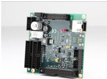
Die praxiserprobten RTC 4 PCI-Ansteuerkarten von SCANLAB erfreuen sich großer Beliebtheit, was Verkaufszahlen von über 20.000 Einheiten seit der Markteinführung belegen. Zu den zentralen Standard-Features gehört beispielsweise die 16-Bit Positionsauflösung und die Unterstützung des weitverbreiteten XY2-100 Standard / Enhanced Protokolls. Letzteres ermöglicht den flexiblen Einsatz zur Steuerung
