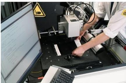
Häufig wird die Laserbearbeitung durch das Bildfeld des Scanners limitiert. Bei großflächigen Bearbeitungsaufgaben erfolgt klassischerweise die Bearbeitung schrittweise, durch Abarbeitung einzelner Bildfelder, sogenannter ‚Kacheln‘. Dieses Verfahren birgt das Risiko von längeren Prozesszeiten und von ‚Stitching-Fehlern‘, also ein Versatz der Markierungen am Bildfeldrand. Um
