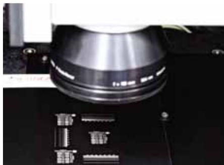
▲ Abb. 4: Testmuster zur Ermittlung von Vibrationen.
